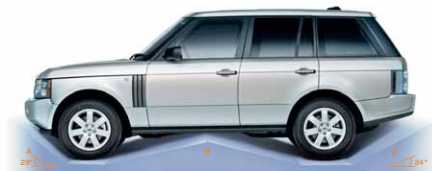
A Angle d'attaque 29° en mode Route, 34° (au bouclier) en mode Tout-terrain
