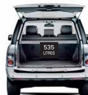
Capacité du coffre Sièges arrière relevés et plage arrière en place : Hauteur 1 002 mm Largeur 1 124 mm Volume de chargement : 535 litres Largeur de l'aire de chargement entre les passages de roues 1 040 mm Longueur 1 082 mm Hauteur sous pavillon Hauteur sous pavillon maximale aux places avant 997 mm – valeur identique avec ou sans toit ouvrant. Hauteur sous pavillon aux places arrière 974 mm
