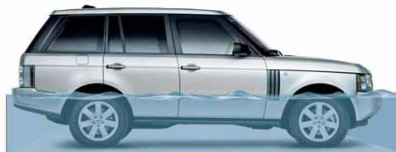
Passage de gué Profondeur de gué maximale 700 mm
