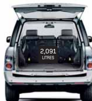
Dimensions du coffre Sièges arrière rabattus Hauteur 1 002 mm Largeur 1 124 mm Largeur de l'aire de chargement entre les passages de roues 1 040 mm Longueur de plancher 1 529 mm Dimensions maximales d'une charge (longueur x largeur x hauteur) 1 265 x 1 024 x 815 mm
